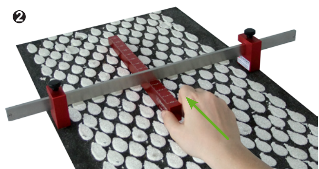
Direction of movement of the wedge / Schieberichtung des Keils
